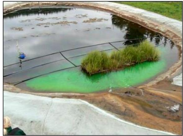
**Abbildung 20: Markierung des Wassers in einem Wetland mit Uranin**
